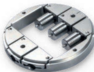
Los blanks para pilares prefresados GenTek™ son compatibles con los soportes Medentika. (Se requiere una actualización de CAM).
