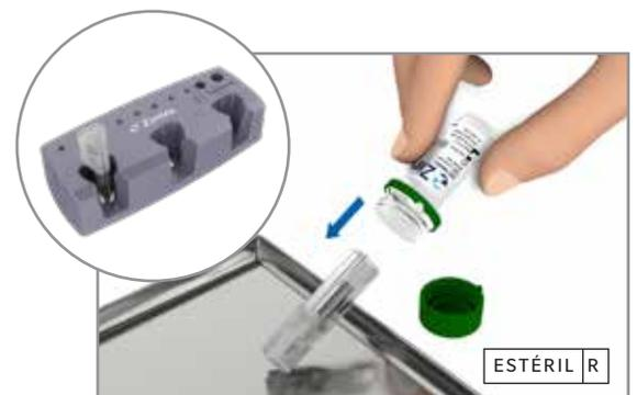
Para abrir el vial interno, presione la tapa del vial interno por el lado plano que tiene el orificio de acceso. Presione la parte superior del cuerpo del vial interno para que quede acoplado en su sitio.
